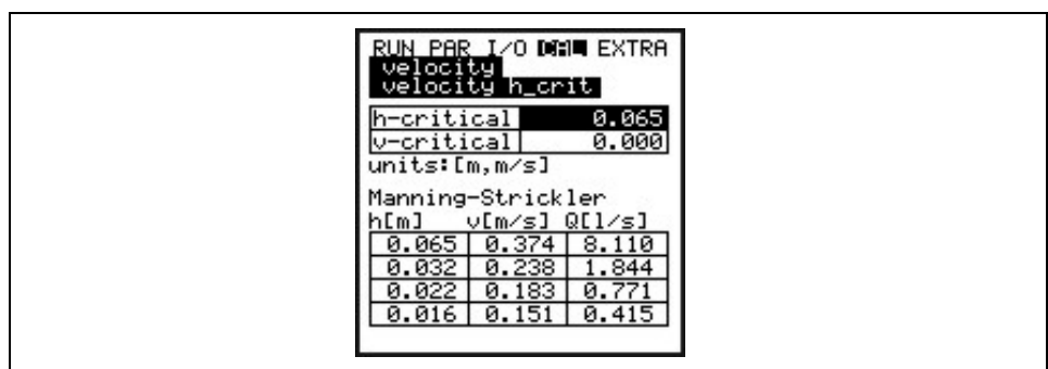
Fig. 8-83 Tabellvärden för automatisk Q/h relation
